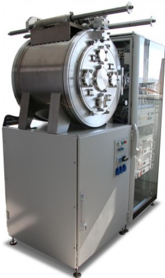
Классическая установка одностороннего напыления проводящих и резистивных слоев серии 2013 на подложки (60x48). Камера стандартного размера (Ø700 x 500 мм), водоохлаждаемая. В единой стойке размещены камера, средства откачки, блоки питания и управления, технологические устройства.
