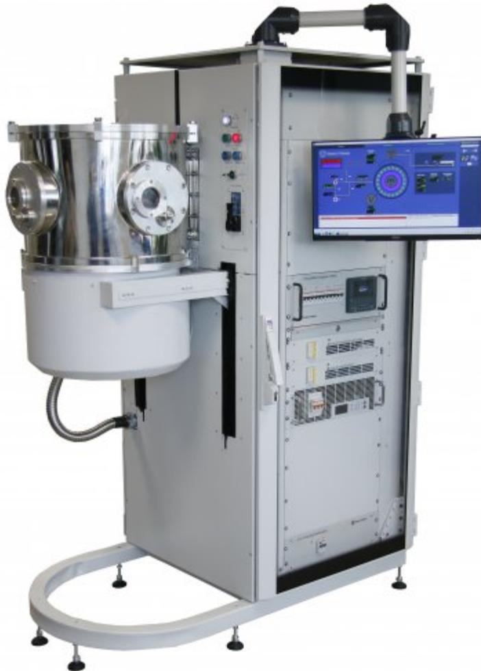
Установка нанесения покрытия Н9 (никеля) (Ника-2012-500 Н9) предназначена для напыления покрытия из никеля (Ni) толщиной 9 мкм (Хим.Н9) на лопатки изделия из титанового сплава ВТ-3 методом катодного распыления мишени в плазме диодного разряда в скрещенных полях.
