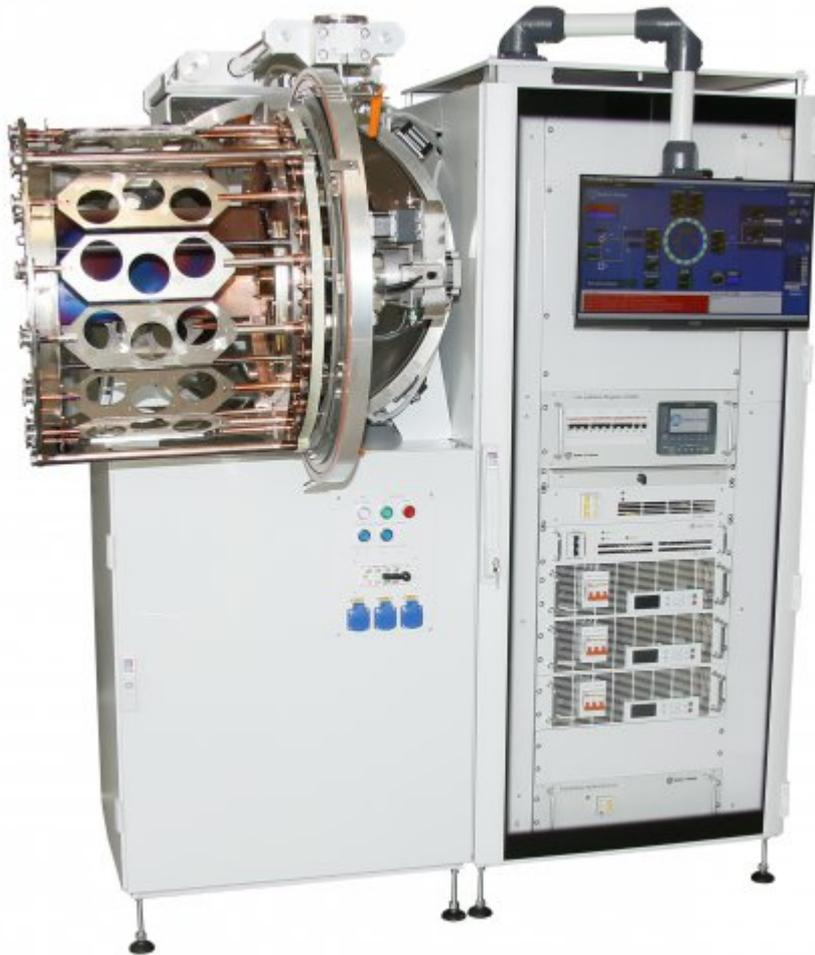
Установка магнетронного напыления НИКА-154 предназначена для двухстороннего магнетронного напыления контактных металлических слоев Cr, Ni, Ti, Ag, Cu толщиной 70-500 мкм на кремниевые подложки двух типоразмеров:  $\varnothing 76$  мм и  $\varnothing 100$  мм. Установка НИКА-154 выполнена на базе вакуумного поста НИКА-2013, в едином конструктиве размещены средства откачки, управления, охлаждения, технологические устройства и блоки питания.
