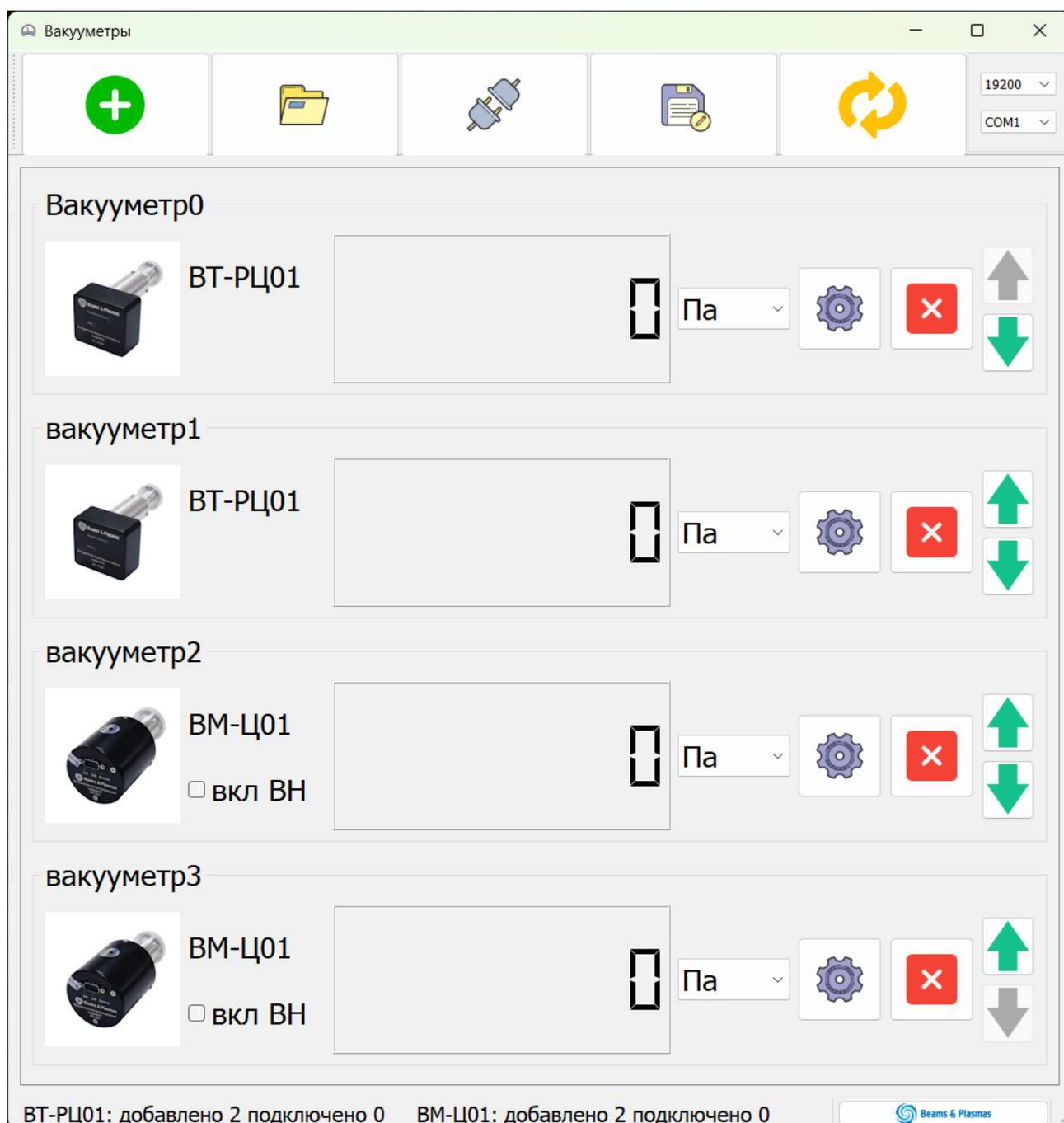
Каждый вакуумметр может отображать показания в трех различных единицах измерения (Паскаль, торр, бар), для смены единиц измерения нужно переключить значение в выпадающем меню после индикатора. Для датчиков типа VM-C01 предусмотрено включение и отключение высокого напряжения.
